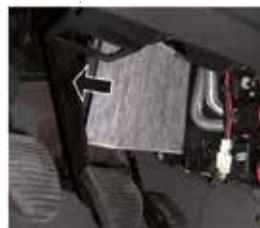
Fig. 3 - Filtro de habitáculo ubicado cerca de los pedales
