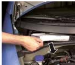
Fig. 2 - Filtro de habitáculo ubicado en el compartimento del motor, debajo del parabrisas
