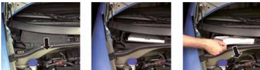
Fig. 2 - Filtre d'habitacle situé à l'arrière du compartiment moteur, sous le pare-brise
