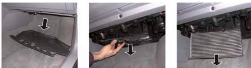
Fig. 1 - Filtre d'habitacle situé derrière la boîte à gants
