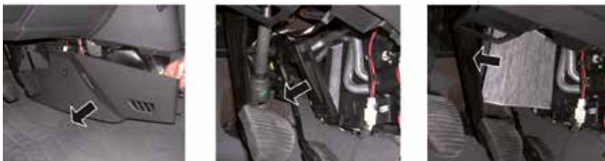
Fig. 3 - Filtre d'habitacle situé près des pédales
