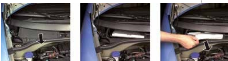
Рис. 2 – Салонный фильтр, расположенный в моторном отсеке, под ветровым стеклом
