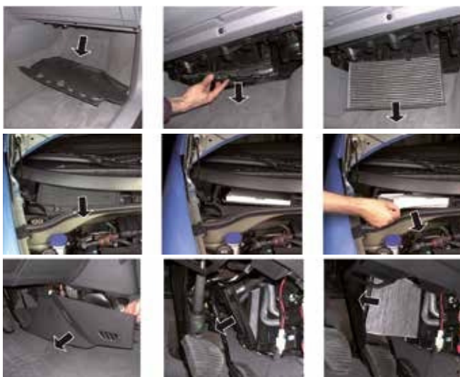
Foto 1 - Innenraumfilter befindet sich hinter dem Handschuhfach
