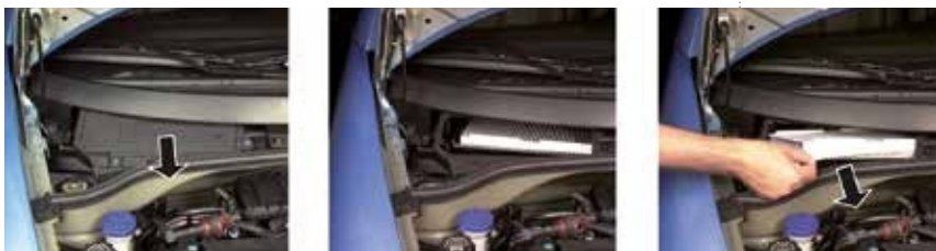
Fig. 2 - Filtro abitacolo situato nella parte posteriore del vano motore, sotto il parabrezza
